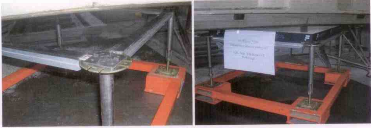
Şekil 4. Ayakları birbirine bağlayan kuşaklar ve bir noktasal köşe yükleme deneyi
